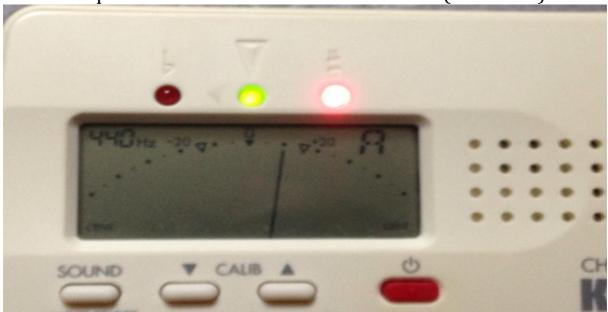
C- Dans ce cas, la corde est trop détendu, pour la tendre, tournez la mécanique associée à la corde vers l'extérieur (horizon).
